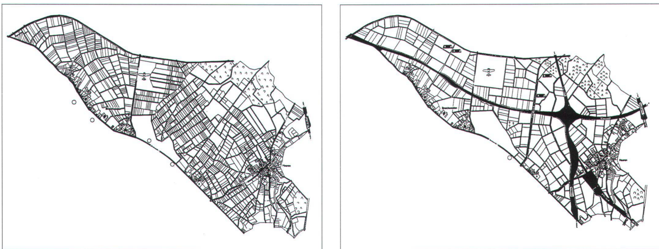
Abb. 2: Zur fachplanerisch-ländlichen Unternehmensflurbereinigung nach dem Flurbereinigungsgesetz; Flurbereinigung Broichweiden zur Realisierung des Autobahnkreuzes Aachen, BAB Köln-Aachen; Belgien-, Hollandlinie (links: alter Zustand, rechts: neuer Zustand). Quelle: Landesamt für Agrarordnung Nordrhein-Westfalen (1972), Münster.
