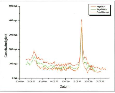
Abb. 4: Fliessgeschwindigkeit des Gletschers an drei Pegeln berechnet aus den GPS-Positionierungen.
