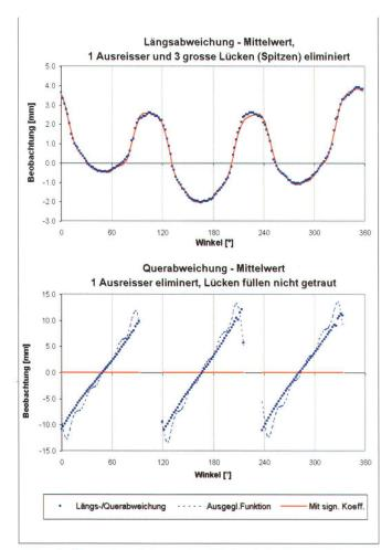
Abb. 8: Querabweichung in Abhängigkeit der Prismenorientierung bei einer Visur unter 50°.
