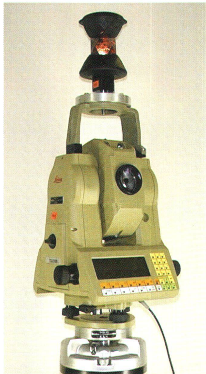
Abb. 4: Montierung des Reflektors.
