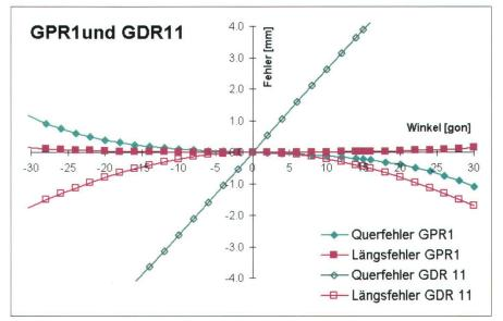
Abb. 3: Theoretischer Längs- und Querfehler.
