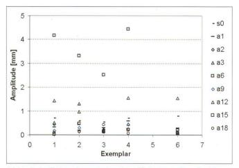
Abb. 6: Reflektorkorrektionskoeffizienten für die Querabweichung, # 1–4: GRZ4, # 6: modifiziertes GRZ4.
