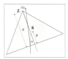
Abb. 2: Querabweichung bei verschwenktem Prisma (Prinzipskizze).
