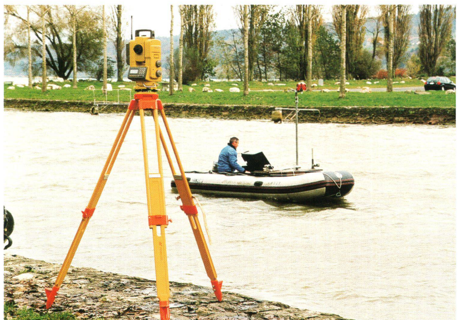
Fig. 3: L'opérateur reçoit en temps réel sa position, ce qui lui permet de naviguer avec précision sur le profil à lever.
