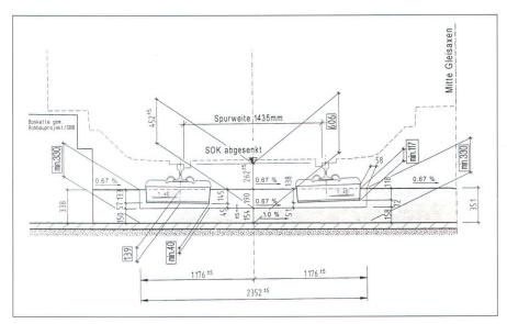
Abb. 1: Querprofil Feste Fahrbahn.
