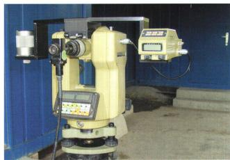
Fig. 2: Sistema di guida ZED-260 con teodolite 71000.
