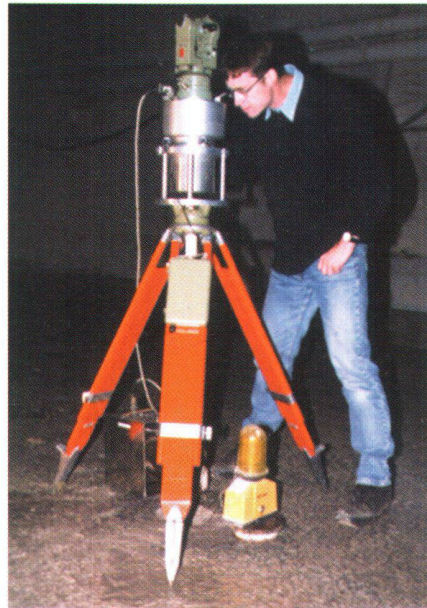
Abb. 2: Gyromat-Messungen im Zimmerbergtunnel.
