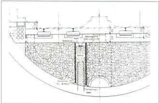
Abb. 4: Fixpunktversicherung im Tunnel.
