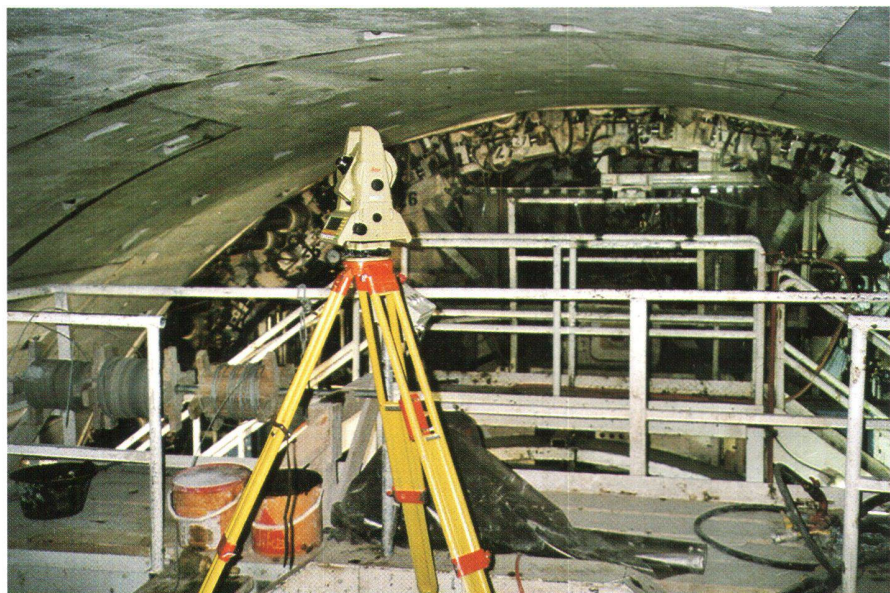
Abb. 1: Konvergenzmessquerschnitt hinter der Ortsbrust.
