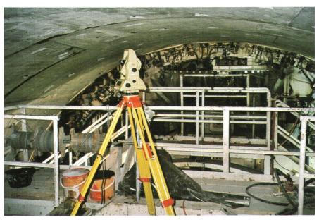
Abb. 1: Konvergenzmessquerschnitt hinter der Ortsbrust.
