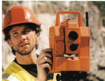
hervorragende Reichweiten. Auf Reflexfolie kann 800 Meter, auf Plastikreflektoren 1500 Meter und auf ein Prisma 5500 Meter weit gemessen werden.
