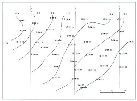
Fig. 4: Ondulation du géoïde en [m].
