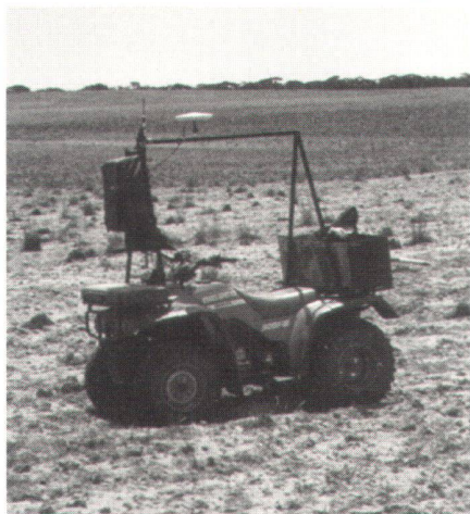
Fig. 3: Equipement GPS utilisé pour dresser des plans topographiques. Plus de 300 ha peuvent être couverts en une journée.
