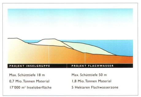
Abb. 4: Das Querprofil durch die beiden Schüttzonen.
