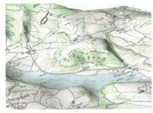
Abb. 2: Ausschnitt eines DHM mit überlagerter Pixelkarte PK25 vom Raum Türlersee (PK25, DHM25: © L+T).
