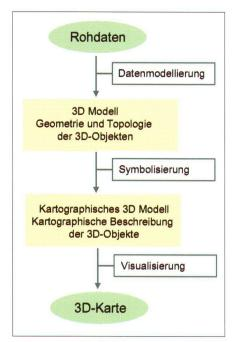
Abb. 3: Ablaufschema zur Entwicklung einer Topographischen 3D-Karte.
