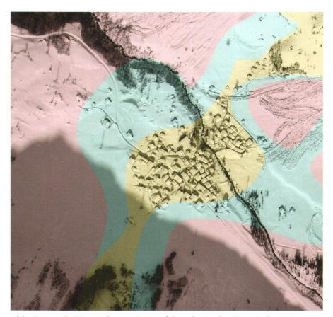
Abb. 9: Ausschnitt aus der Lawinengefahrenkarte der Gemeinde Guttannen, die aus dem Lawinenkataster (Abb. 8) agbeleitet wurde. Die hinterlegte Orthofoto der Lawinenzüge vom Februar 1999 zeigt, dass Lawinen zum Teil die rote Gefahrenzone durchbrochen haben.
