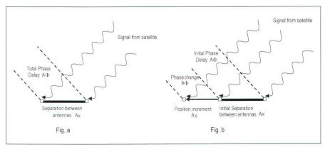
Abb 2: Messprinzip mit Trägerphase.
