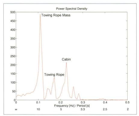
Abb. 5: Frequenzspektrum der Schwingungen des Laufwerkes beim Nothalt: Der stärkste Ausschlag mit einer Periodendauer von 9.1 Sekunden wird durch die bewegliche Spannmasse des Zugseils verursacht. Die Schwingung mit einer Frequenz von 0.17 Hertz wird vermutlich durch das Zugseil selber angeregt. Die Periode der Längspendelung der Kabine beträgt 4.4 Sekunden.
