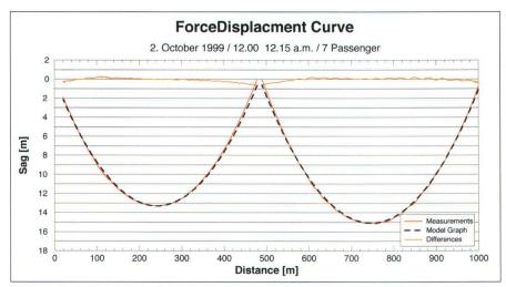
Abb. 2: Lastwegkurve. Die Modellkurve (schwarz gestrichelt) wurde mit den Sollparametern der Anlage berechnet. Die Differenzen (gelb) zeigen gegen die Auflagepunkte hin systematische Abweichungen der Messungen (rot) vom Modell. Dies ist vornehmlich durch die Modell-Näherung (kubische Parabel) bedingt.
