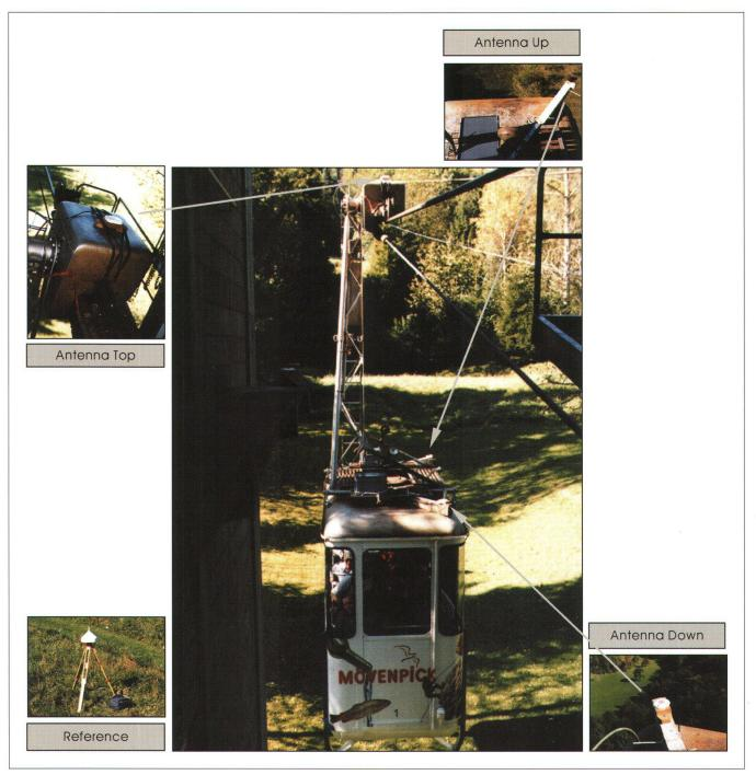
Abb. 1: GPS-Ausrüstung auf der Kabine.
