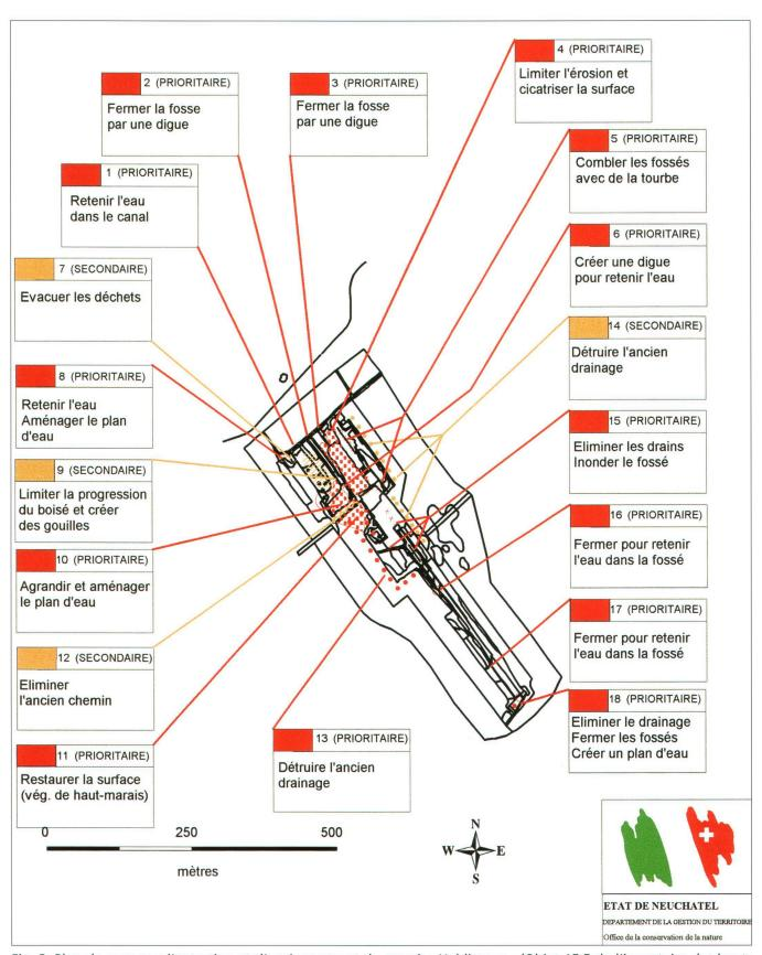
Fig. 3: Plan de mesures d'entretien et d'aménagement du marais «Haldimann» (Objet 15.5 de l'inventaire des hauts marais).
