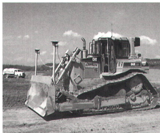
Site Vision, Trimble GPS-Maschinensteuerung Flughafen Zürich
