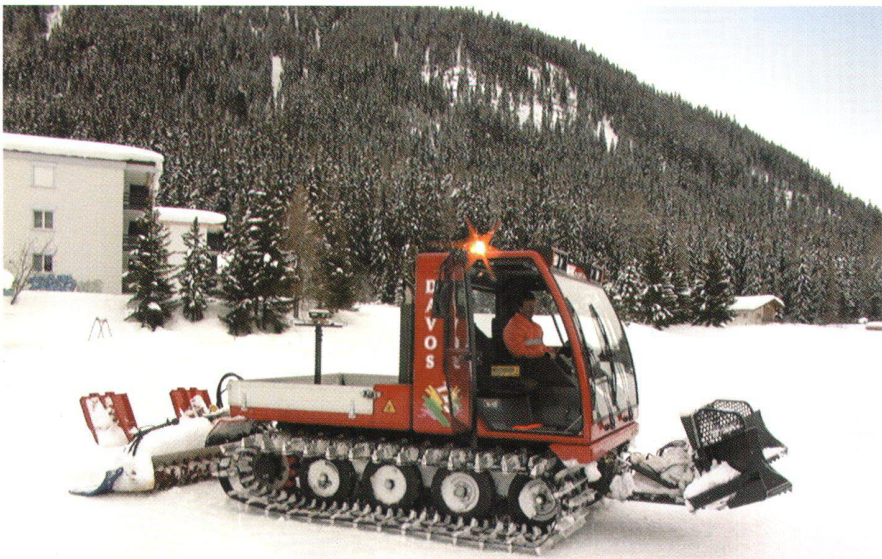
Abb. 1: Loipenfahrzeug mit Antenne auf der hinteren Plattform fest montiert und Empfänger (Trimble 4000SST) auf dem Beifahrersitz. Die Antenne konnte nicht höher montiert werden, da vorbeistreichende Äste sie sonst gefährdet hätten.
