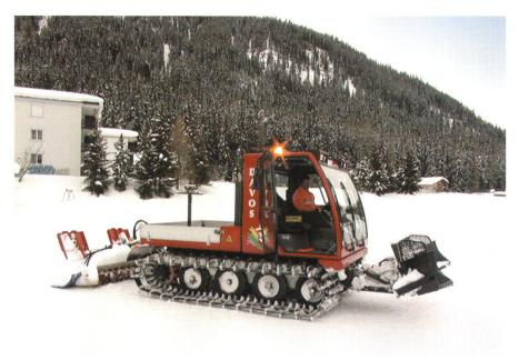
Abb. 1: Loipenfahrzeug mit Antenne auf der hinteren Plattform fest montiert und Empfänger (Trimble 4000SST) auf dem Beifahrersitz. Die Antenne konnte nicht höher montiert werden, da vorbeistreichende Äste sie sonst gefährdet hätten.
