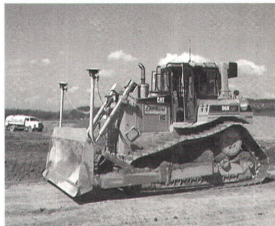
Site Vision. Trimble GPS-Maschinensteuerung Flughafen Zürich
