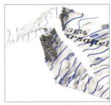
Abb. 5: Terrainmodell aus Lasermessungen generiert. Zur Verdeutlichung sind die Signaturen der Landeskarte eingedruckt. Weisse Gebiete zeigen Laser-Datenausfälle. Die Auflösung ist an den Gletscherspalten zu erkennen.
