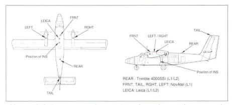
Abb. 3: Mehrfachantennen. Mehrere GPS-Empfänger können dazu verwendet werden, die Lage des Flugzeugs im Raum zu bestimmen. Die GPS-Daten werden zur optimalen Lagebestimmung mit den Gyro-Daten integriert.
