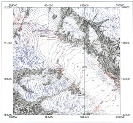
Abb. 4: Höhenlinien [m] aus Laserscanning (rot) mit einer Äquidistanz von 20 m dem entsprechenden Ausschnitt der Landeskarte 1:25 000 überlagert. Im steilen Firngebiet in der nordwestlichen Ecke decken sich die Kurven gut. Im flachen Teil des Gletschers liegt die mit Laserscanning gemessene Gletscheroberfläche rund 10 m tiefer als zur Zeit der Aufnahme der Höhenkurven. In den stabilen Felspartien weist die gute Überdeckung der Höhenkurven auf die Güte der Messung hin.
