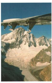
Abb. 1: Finsteraarfirn. Gebiete mit wenig Textur (Schatten, Schneeflächen) führen zu Schwierigkeiten bei der photogrammetrischen Auswertung.
