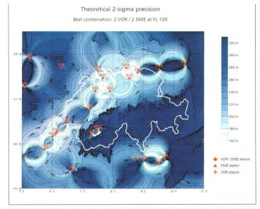
VOR/DME). Die Flughöhe entspricht dem FL 100 (Flight Level 100, ca 3050 m). Dieses Bild ergibt sich, wenn der Bordempfänger permanent zu den zwei optimalst gelegenen Bodenstationen misst (Cerniar, 1998; GGL-ETHZ).
