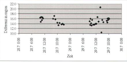
Abb. 4: Differenzen der Kreiselazimute zu den Azimuten aus Koordinaten.
