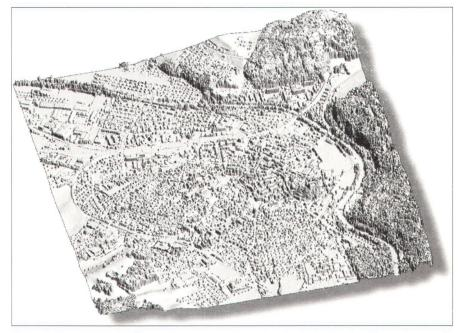
Abb. 4: Datenbeschaffung: Laserscanning als ein Beispiel der Datenbeschaffung. Eine moderne, schnelle und sehr detaillierte Methode zur preisgünstigen 3D-Modellierung grösserer Gebiete. Höhenbestimmung mit oder ohne Vegetationsdecke (z.B. Wald) (© Grunder Ingenieure AG).
