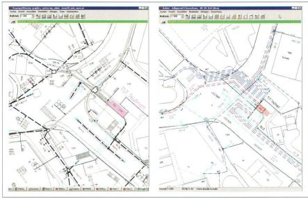
Werkplan Strom (links) und Geoschema Strom (rechts).
