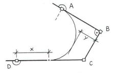
Die Ecke eines Grundstückes soll neu durch einen Kreisbogen begrenzt werden. Berechne x und y.
