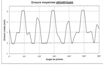
Fig. 2: Précision du GRZ4 en fonction de son angle d'exposition.
