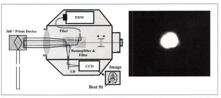
Fig. 1: Image numérique d'un prisme GRZ4 perçue par le capteur CCD d'un TCA1800.
