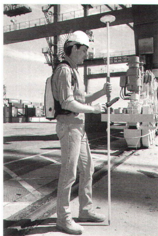
Echtzeit kinematische Messung mit dem SR530.
