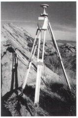
Rapid-Static Vermessung mit dem System 500.
