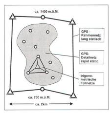
Abb. 3: Netzaufbau schematisch.
