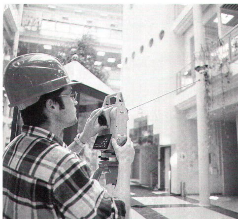
Neben klassischen Totalstationen umfasst die TPS300 Basic Series auch reflektorlos messende Totalstationen (TCR-Modelle) – eine echte Premiere in dieser Klasse!
