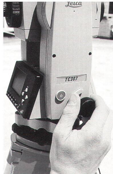
Endlos-Trieb und seitlicher Mess-Auslöser gewähren dem Benutzer erhöhten Messkomfort.
