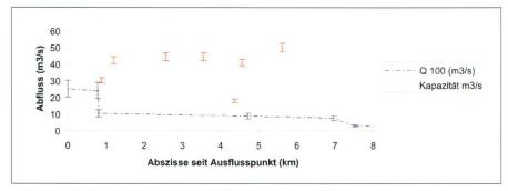
Abb. 8: Vergleich der Projekt-Abflüsse (Regionalisierung) und der Kapazität der Querschnitte, (Berechnung der Wasserlinie) der Querschnitte entlang der Mèbre in ihrem Lausanner Abschnitt<sup>6</sup>.
