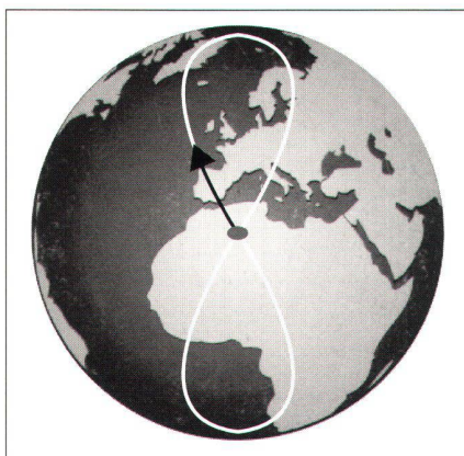
Fig. 3: Trace d'une orbite de type IGSO.
