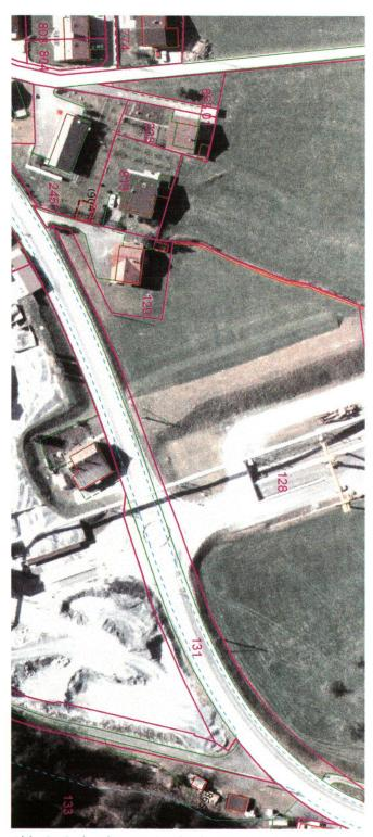
Abb. 2: Orthophoto mit überlagerten Vektordaten aus dem Grunddatensatz des Nachführungs-Geometers. Informationsebenen Bodenbedeckung, Einzelobjekte und Linienelemente, Liegenschaften.
