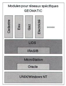
Fig. 1: Architecture du système d'information des SIG.
