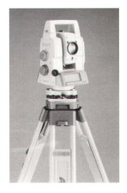
ierlich und für die Genauigkeit optimal beschleunigt oder gebremst. Moderne Computertechnologie gehört selbstverständlich ebenfalls zur Ausstattung der Hochleistungsinstrumente. So können Sie Ihre Daten sowohl im internen Speicher als auch auf Speicherkarten oder direkt über eine Standardschnittstelle im PC ablegen. Bis zu 30 000 Punkte können im Gerätespeicher gesichert werden, sollte das nicht genügen, nutzen Sie die PCMCIA-Karten.
