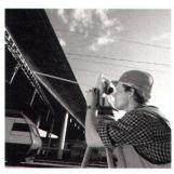
Abb. 2: Reflektorlose Messung über Hindernisse – mit TCRA bequem, schnell und genau.
