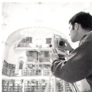
Abb. 3: Innenaufnahme einer Bibliothek mit TCRA. Seine reflektorlose Messtechnik mit sichtbarer Zielpunktmarkierung bietet sichtliche Vorteile und erhöht die Produktivität.
