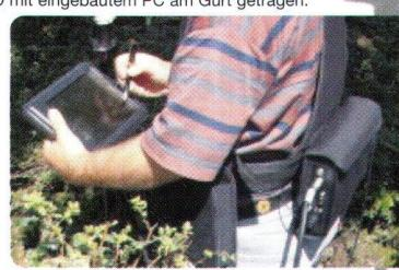
Der Vorteil des Rover-Combi 1 besteht darin, dass außer den Verbindungen vom Bildschirm zum Empfänger mit eingebautem PC und zum Akku sowie zu den Antennen sämtlicher «Kabelsalat» entfällt. Ein einziger Akku versorgt alle Geräte und dessen Kapazität wird auf Knopfdruck angezeigt.
