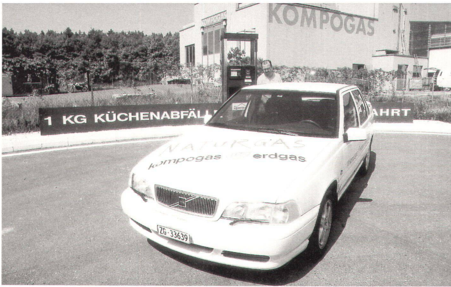
Abb. 2: Mit Kompogas betriebener Volvo S70 (Hybridfahrzeug) vor der Kompogas-Anlage und -Tankstelle in Bachenbülach (Foto: W. Schmid AG, Glattbrugg).
