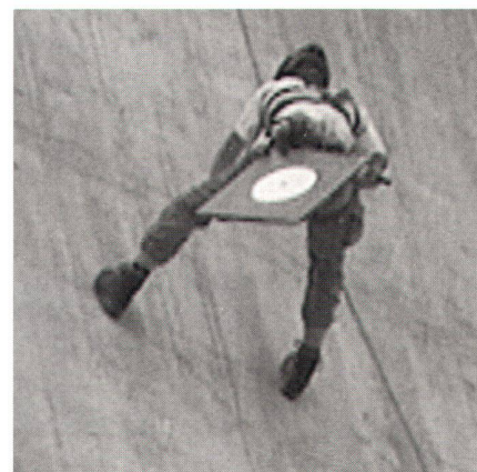
Abb. 2: Anbringen der Zielmarken an der Staumauer.
