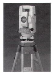
La station totale Topcon GPT-1000 ouvre de nouvelles possibilités pour plusieurs mandats spéciaux de la mensuration. Cette station totale mesure jusqu'à une distance de 100 m sans réflecteur et à plus de 4000 m avec un seul prisme.
