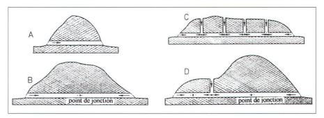
Fig. 2: Méthodes de percement de tunnel. A: depuis un côté. B: depuis les deux côtés. C: au moyen de puits verticaux. D: méthode combinée.
