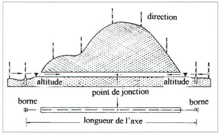
Fig. 1: Informations principales nécessaires au percement de tunnel.
