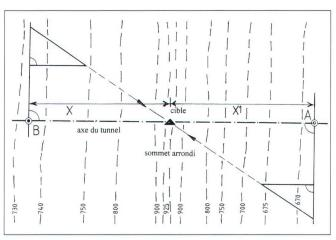
Fig. 4: Triangulation au-delà du sommet d'une montagne pour l'obtention de la longueur de l'axe.
