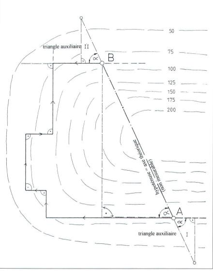
Fig. 5: Cheminement à côtés orthogonaux selon Héron pour la détermination de la longueur et de la direction de l'axe d'un tunnel.
