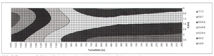
Abb. 6: Temperaturfeld im Albula-Tunnel (variabler Massstab auf der y-Achse).
