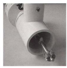
Abb. 2: Montierung des Pt1000-Chip-Sensors und Pt1000-Standard-Sensors.
