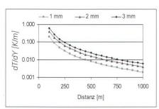
Abb. 1: Erforderliche Temperaturgradientenmessgenauigkeit für eine Unsicherheit in der Querabweichung von 1–3 mm.
