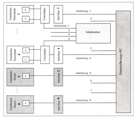
Abb. 3: Aufbau des Messsystems (S = Standardsensor; C = Chipausführung).
