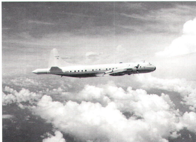
Abb. 3: Das Forschungsflugzeug «Electra»: Eines von acht «fliegenden Labors», die im Herbst 1999 im Forschungsprogramm MAP eingesetzt werden. Im Heck des Flugzeuges ist ein duales Doppler-Radar untergebracht, mit welchem die dreidimensionale Struktur von Starkniederschlagszellen ausgemessen werden kann (Foto: NCAR, Boulder).
