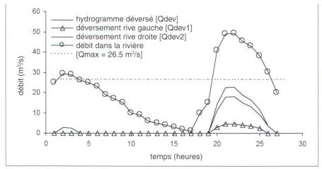
Fig. 13: Scénario hydraulique pour la Petite-Glâne.
