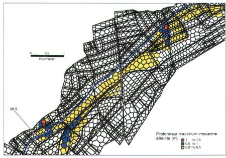
Fig. 15: Profondeurs maximales probables (en mètres).
