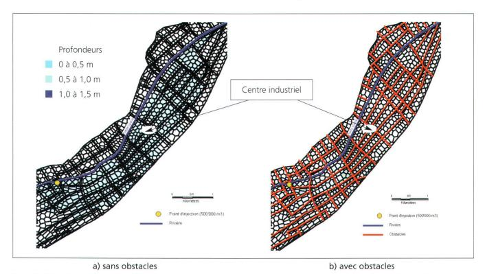
Fig. 10: Effet des obstacles sur l'étendue des zones submergées (Scénario hydraulique: ½ millions de m³ déversés pendant 1 heure à l'amont de la zone d'étude).
