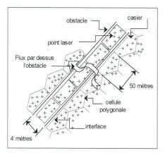
Fig. 11: Restitution des obstacles à partir des points «laser».
