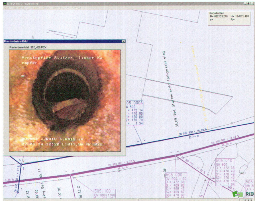
Abb. 2: Sämtliche Haupt- und Sammelleitungen, die fünf Jahre und älter waren, wurden in die TV-Befahrung einbezogen. Das mit den ausgeschrieben Arbeiten zur vorbereitenden Kanalspülung beauftragte Unternehmen erhielt die relevanten Leitungs-Koordinaten digital.
