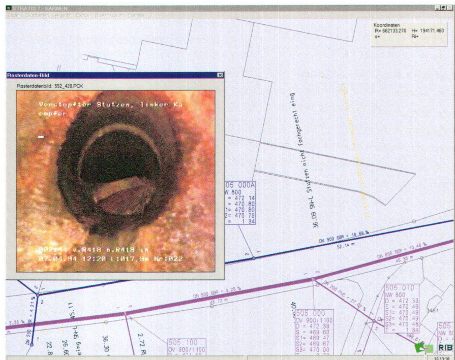
Abb. 2: Sämtliche Haupt- und Sammelleitungen, die fünf Jahre und älter waren, wurden in die TV-Befahrung einbezogen. Das mit den ausgeschriebenem Arbeiten zur vorbereitenden Kanalspülung beauftragte Unternehmen erhielt die relevanten Leitungs-Koordinaten digital.
