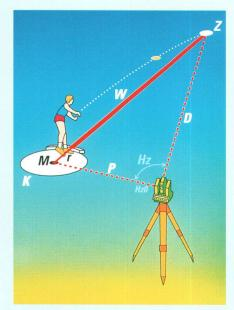
Abb. 9: Die Tachymeter-Messmethode auf dem Sportplatz des Jahres 1997 beruht auf moderner optoelektonischer Winkel- und Distanzmessung sowie auf einfachen geometrischen Gesetzen. Die reine Messung selbst erfolgt in nur zwei Sekunden mit Millimetergenauigkeit.
