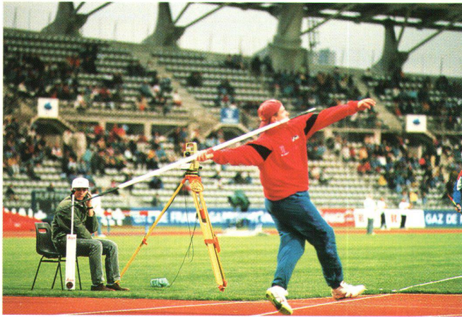
Abb. 5: Der Speer fliegt von allen Sportgeräten der Leichtathletik am Weitesten: bei 98,48 m Meter liegt der Weltrekord von Jan Zelezny. Hier auf dem Bild aus dem Pariser Charlety-Stadion erkennt man links die weiße Messmarke für grosse Distanzen. Der automatisierte Leica Tachymeter fokussiert sich auf das unten eingebaute Prisma selbst. Ab 1998 werden erstmals auch ungerade Zentimeterangaben in den Ranglisten erscheinen. Die neue Messtechnik gestattet dies nun. (Foto: Leica/Stf)
