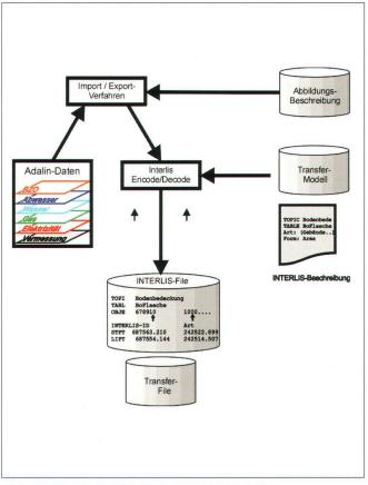
Abb. 6: Prinzip INTERLIS-Datenschnittstelle.
