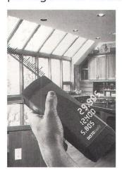
Mit DISTO basic stellt Leica eine Weiterentwicklung der bereits tausendfach bewährten DISTO Hand-Lasermeter-Generation der Weltöffentlichkeit vor. DISTO basic wurde nach neuesten Erkenntnissen der Lasertechnik für ein schnelles und berührungsloses Messen von Distanzen entwickelt und gebaut. Ein sichtbarer, roter Laserstrahl ermöglicht dem Benutzer, per Knopfdruck aus der Hand, ein punktgenaues Anzielen des Messobjekts. Dabei
