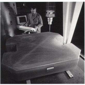
Vermessung des ZERODUR-Blocks für den 1x1 m grossen Prototypen eines Ringlaserkreisels bei Carl Zeiss in Oberkochen.
