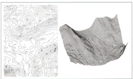
Abb. 4: Referenzdatensatz (Gitterpunkte). Links: Höhenlinien mit 10 m Äquidistanz. Rechts: 3D-Drahtgittermodell.
